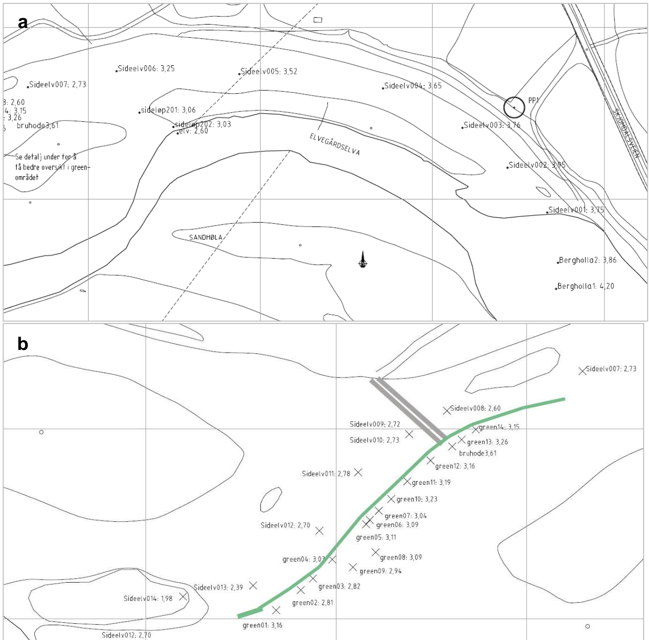
Figur 3 Kart som viser oppmålte høyder langs eksisterende bunn i sideløpet og langs "green"-området ved hull 10. Kart a viser øvre del av sideløpet, mens kart b viser nedre del (ved hull 10).
