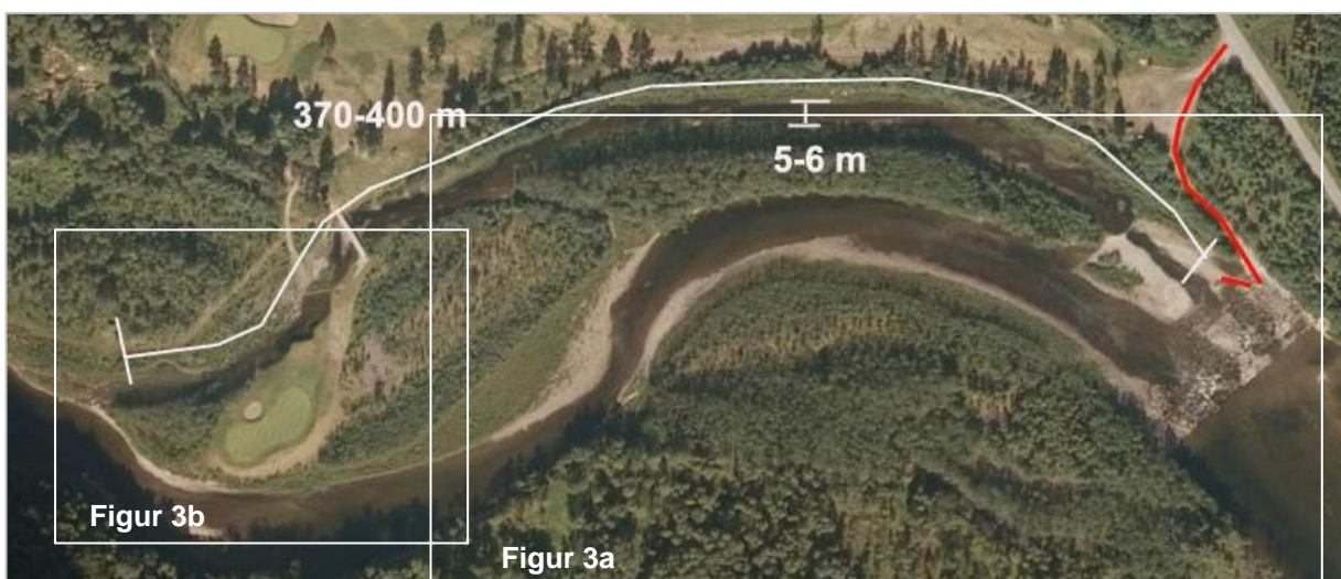
Figur 2 Sideløpet nedstrøms Berghøla. Sideløpet er angitt med omtrentlige mål, og rød heltrukket linje viser eksisterende vei ned til Berghøla-terskelen.
